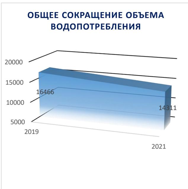
модернизировало предприятие и внедрило оборудование, которое функционирует с использованием водооборотных циклов. Внедрение данного оборудования позволило сократить объёмы потребления воды за период с 2019 года по 2021 год **на 13,1 %.**
